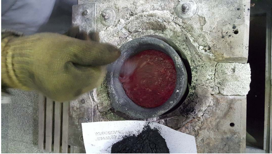
Şekil 2.1. Al7075 matris içine ilave edilen B 4 C takviyesi
