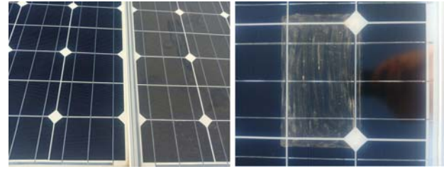
Şekil 6. Temiz ve tozlu panel – Tozlandırılmış hücre
