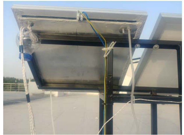
Şekil 3. Soğutulan panelin tamamlanmış arka görüntüsü
