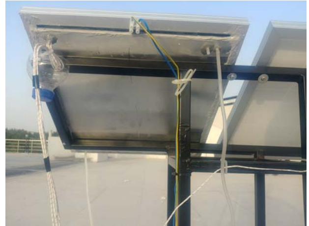
Şekil 3. Soğutulan panelin tamamlanmış arka görüntüsü
