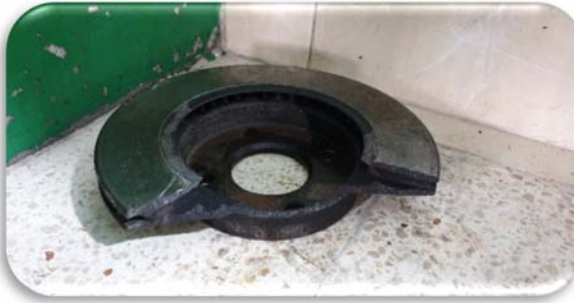
Hasar almış sağ tekerlek fren diski
