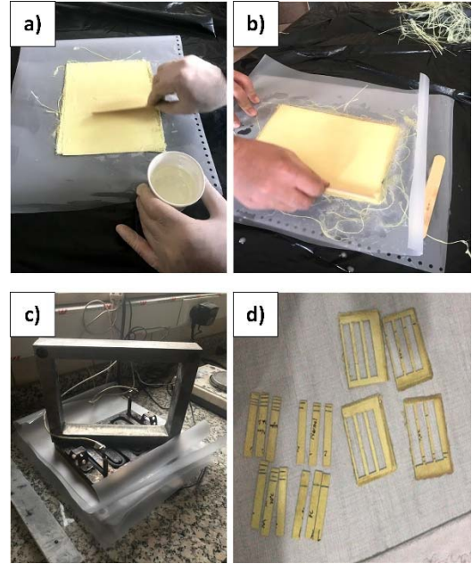
Şekil 1. a) ve b) epoksi reçinenin aramid katmanlarına elle yatırma işlemiyle sürülmesi, c) ısı kontrollü üretim, d) numunelerin su jeti ile kesimi.
