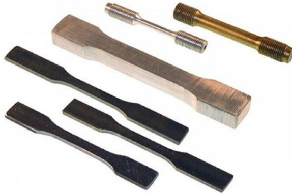
Şekil 1. Çeşitli malzemelerin çekme deneyi standart geometrileri
